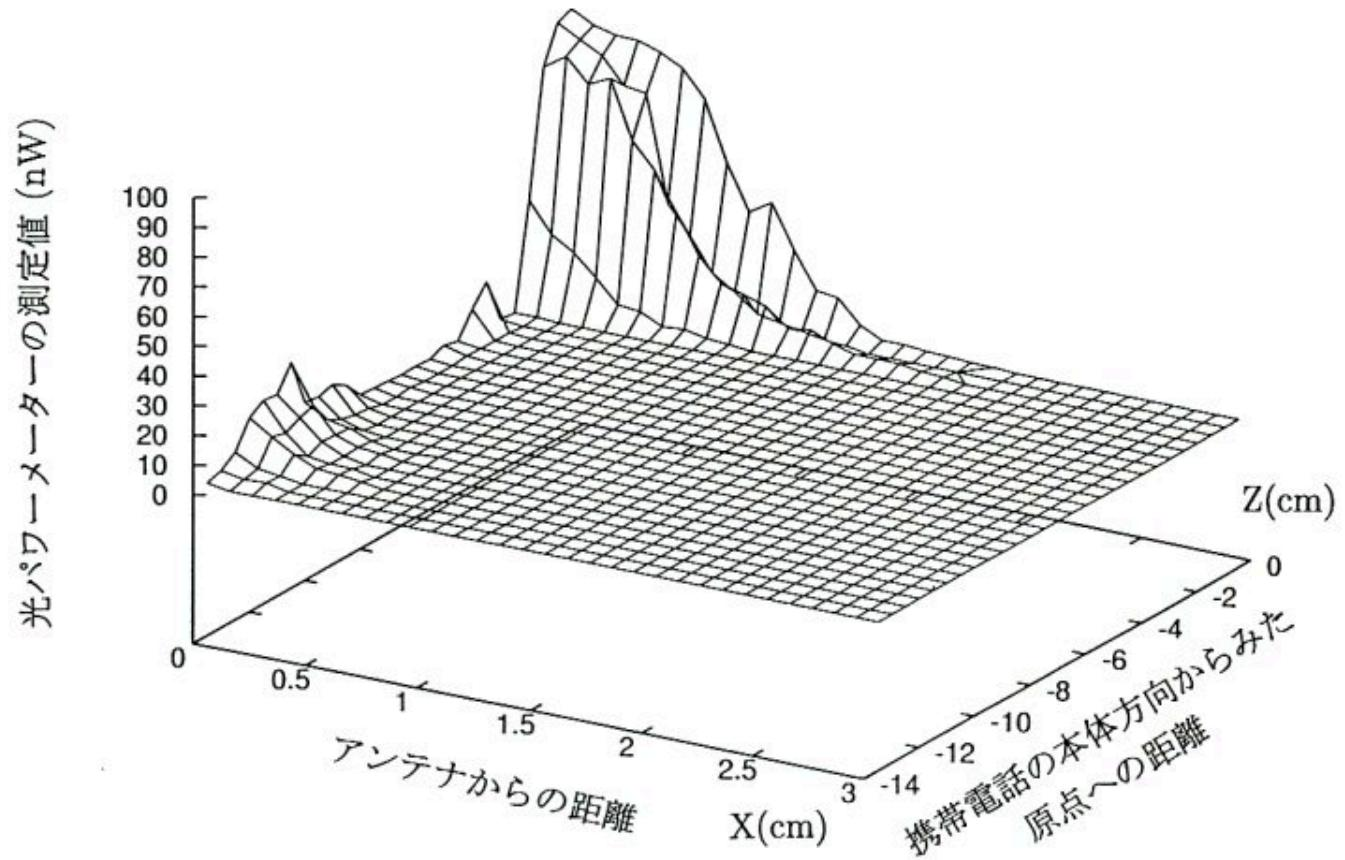
図 3.6 携帯電話本体を観測したときの小型センサの発光強度分布
