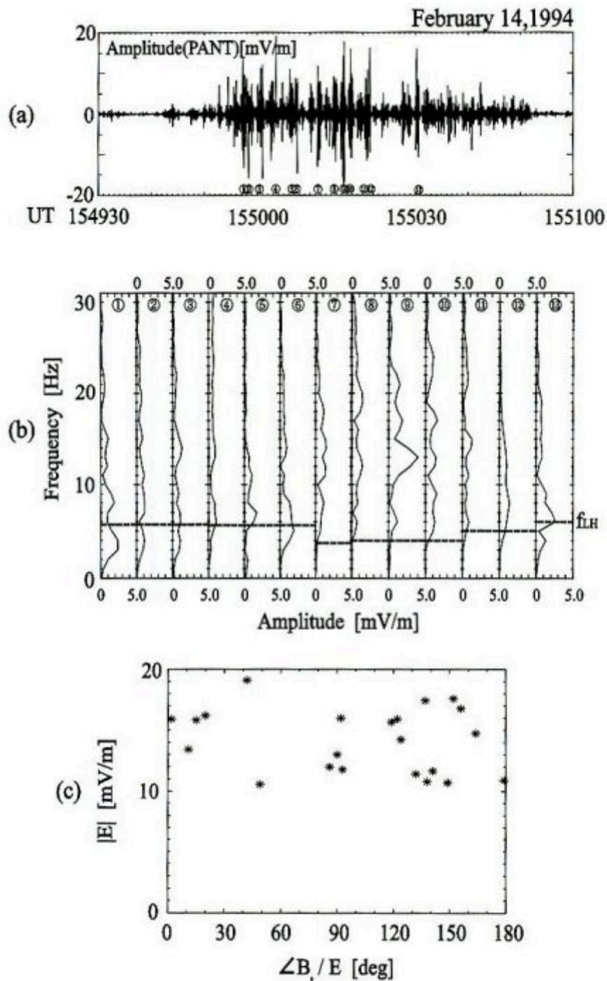
図 A.26 1994.2.14, 15:49:30~15:51:00 UT の (a)PANT による電界波形, (b) 図 (a) に示す各区間 (1 秒間) の電界スペクトル, (c) 地球磁場に対する電界ベクトルのなす角と電界の振幅のピーク値との関係
