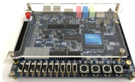
図2 FPGA評価ボード
