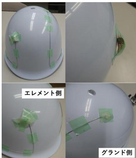
図 1.試作したヘルメットアンテナ
