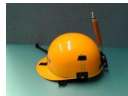
図 2 試作したアンテナ
